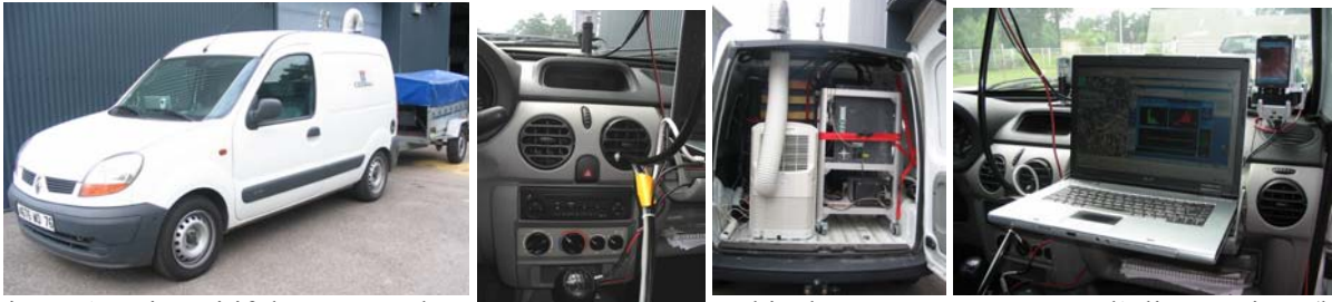
Figure 1 : Dispositif de mesure, de gauche à droite : (a) véhicule avec remorque pour l'alimentation, (b) prélèvement dans l'habitacle (c) climatisation et appareils de mesure (d) PC de contrôle et GPS
